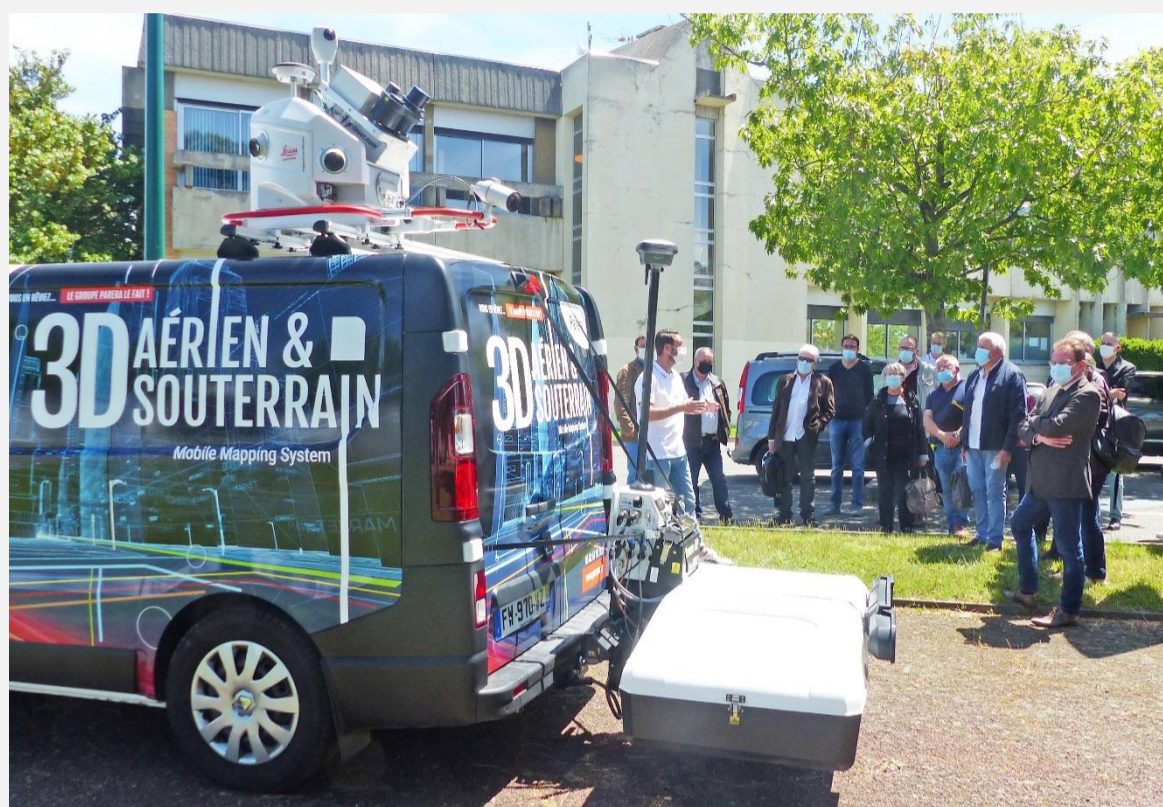
Le Président du SDEHG, Thierry Suaud, et les membres du Bureau, ont participé à la présentation d'un véhicule équipé d'un Stream up (à l'arrière du véhicule) relevant les informations du sous-sol et d'un Mobile Mapping System (sur le toit) qui récolte des informations aériennes.
